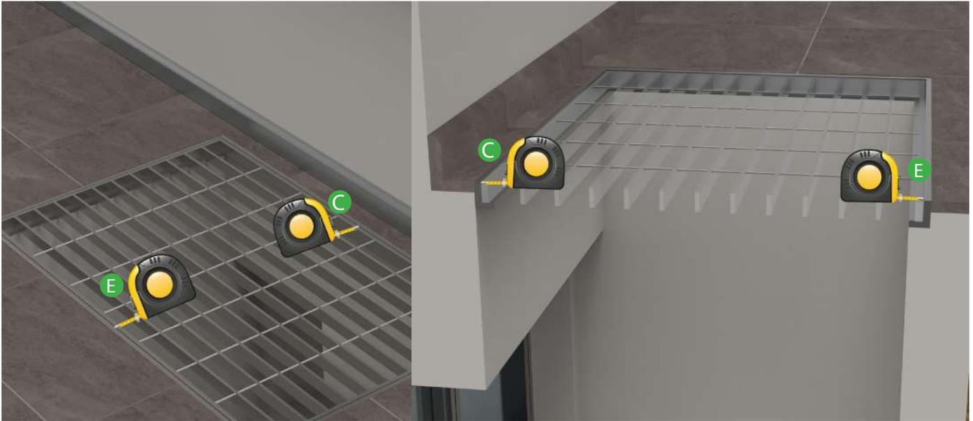
MISURARE L'INTERNO ORIZZONTALE PUNTANDO IL METRO ALL'INTERNO VERTICALE DEL TELAIIO.
