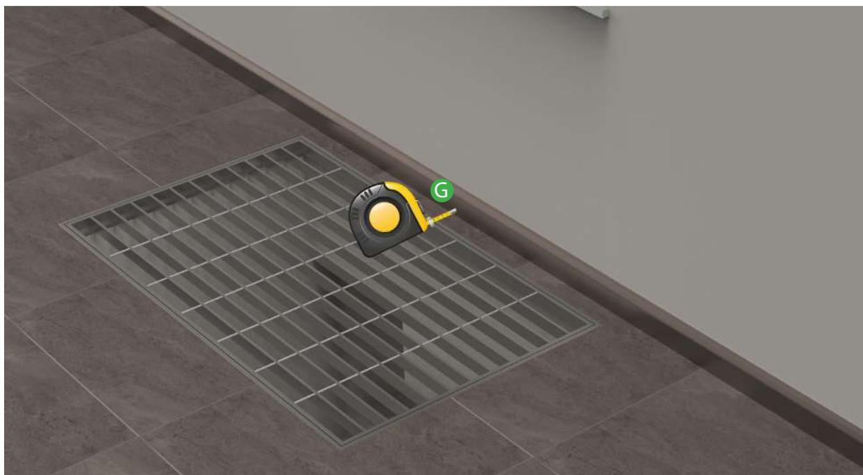
MISURARE LA DISTANZA TRA IL BATTISCOPA E L'INTERNO VERTICALE DEL TELAIO, PUNTANDO IL METRO CONTRO IL BATTISCOPA.
