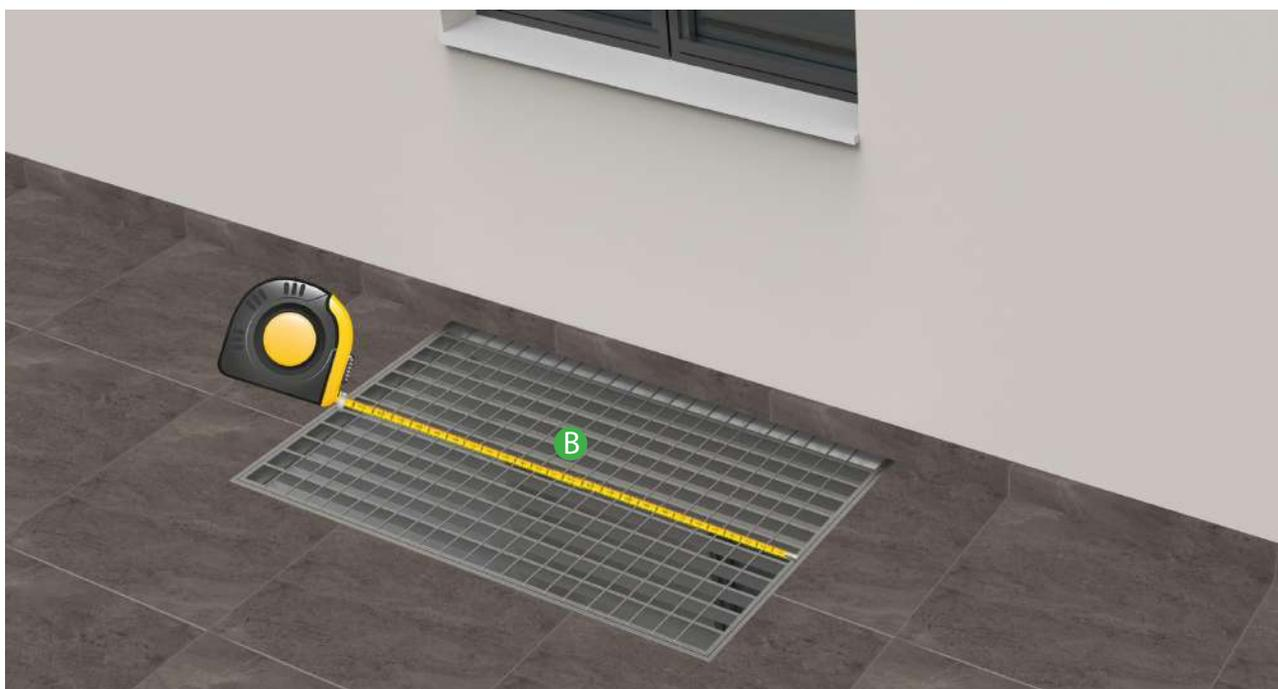
MISURARE IL LATO LUNGO PUNTANDO IL METRO ALL'INTERNO VERTICALE DEL TELAIO. SUL LATO OPPOSTO, LEGGERE LA MISURA IN CORRISPONDENZA DELL'INTERNO VERTICALE DEL TELAIO.
