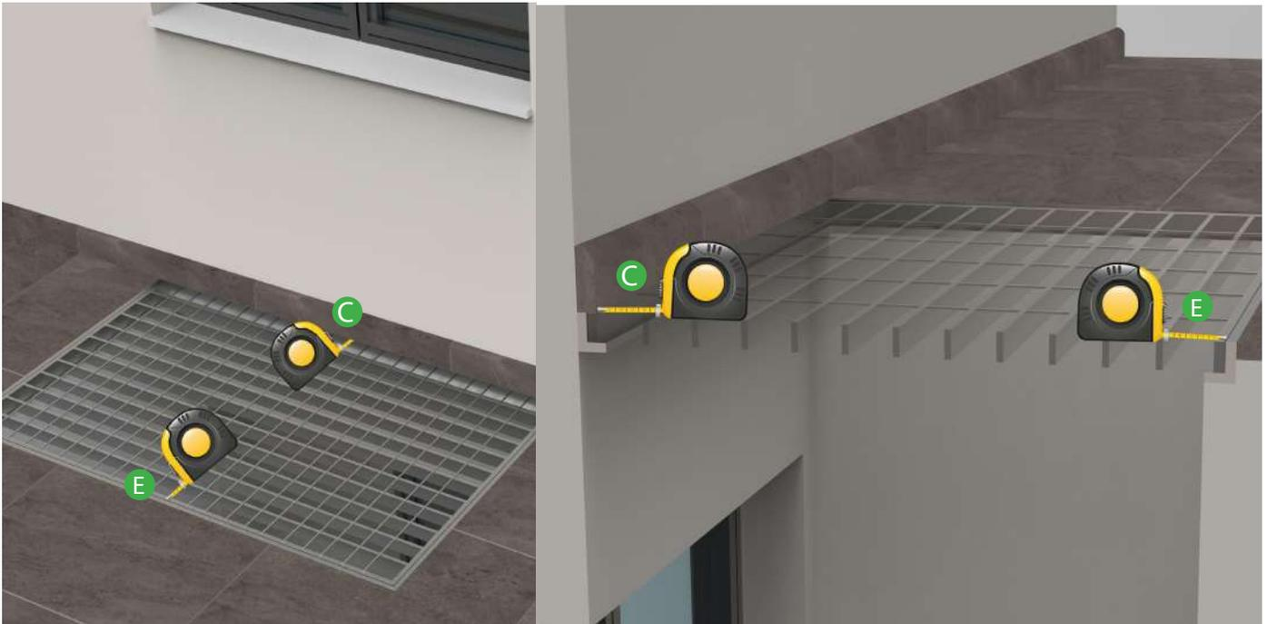
MISURARE L'INTERNO ORIZZONTALE PUNTANDO IL METRO ALL'INTERNO VERTICALE DEL TELAIIO.
