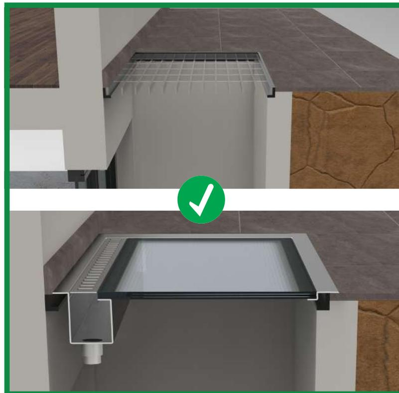
In alcuni casi il cemento sporge rispetto al telaio dove alloggia la griglia, ciò può costituire impedimento all'installazione del Lucernario aerante. Per ovviare a questo problema è necessario misurare l'ingombro generato dal muro puntando il metro in punti specifici come mostrato nelle pagine precedenti.
